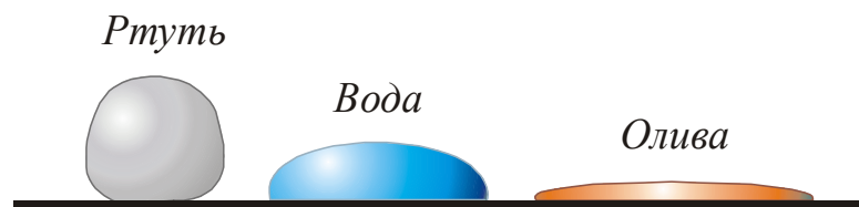
Рис. 7.18 Приклади змочування поверхні рідиною
