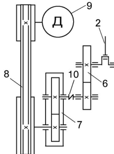
1 – кривошип; 2, 4 – шатун; 3 – коромисло, 5 – повзун; 6 – відкрита зубчаста передача; 7 – редуктор, 8 – пасова передача, 9 – двигун, 10 - муфта.
