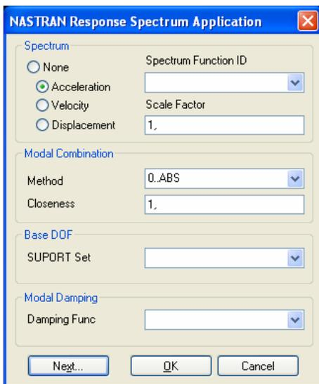
Рис.7.6. Диалоговая панель для подготовки расчета полной реакции спектрального отклика тела
