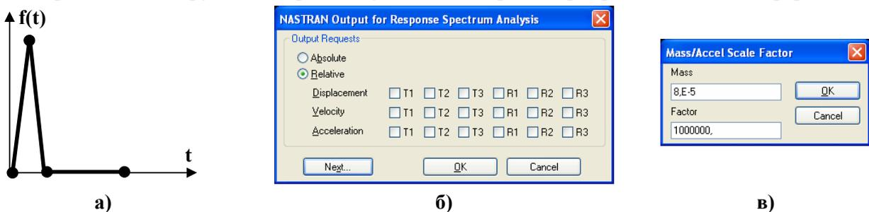
Рис.7.4. График функции нагрузки (а); диалоговые панели для назначения: б) – направлений перемещений (T1, T2, T3) и вращений (R1, R2, R3) трех типов величин; в) – задание массы и масштабного коэффициента для ускорения
