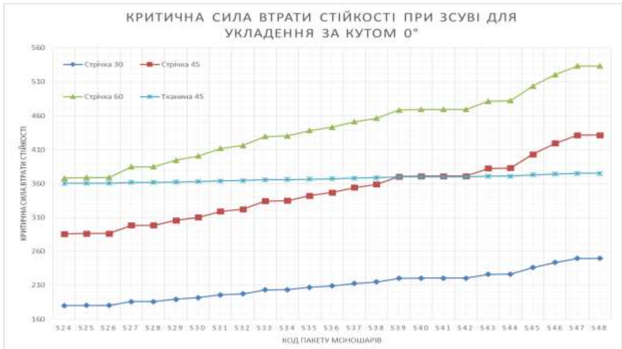
Рис. 3.21. Залежність критичної сили втрати стійкості від пакету моношарів
