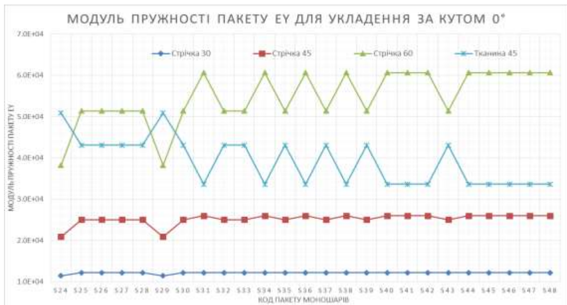
Рис. 3.7. Модулі пружності для пакетів з кутами укладення 0^\circ та 30^\circ , 45^\circ , 60^\circ
