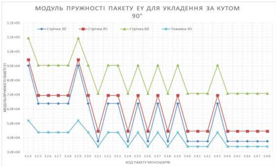
Рис. 3.8. Модулі пружності для пакетів з кутами укладення 90^\circ та 30^\circ , 45^\circ , 60^\circ
