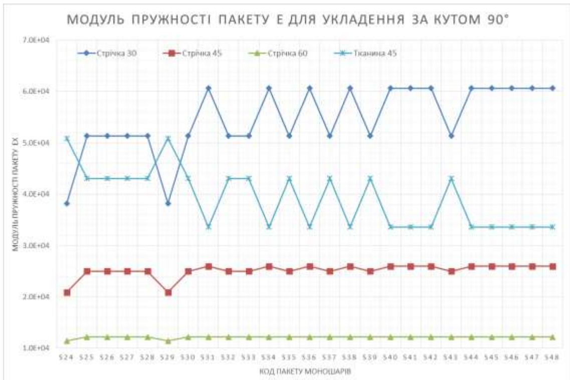
Рис. 3.6. Модулі пружності для пакетів з кутами укладення 90° та 30°, 45°, 60°
