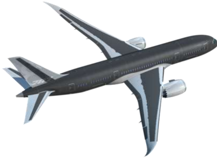
Рис. 1.1. Boeing 787-8 Dreamliner: темним кольором позначені елементи конструкції, виготовлені із використанням вуглепластику.
