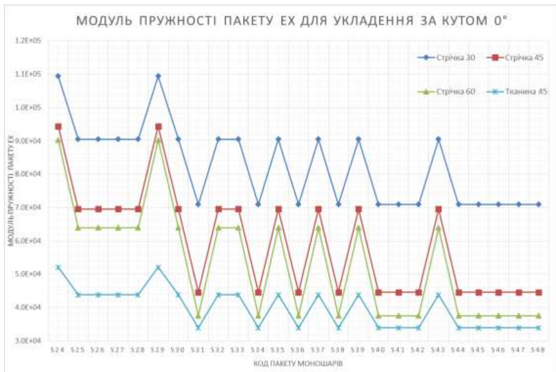
Рис. 3.4. Модулі пружності для пакетів з кутами укладення 0^\circ та 30^\circ , 45^\circ , 60^\circ
