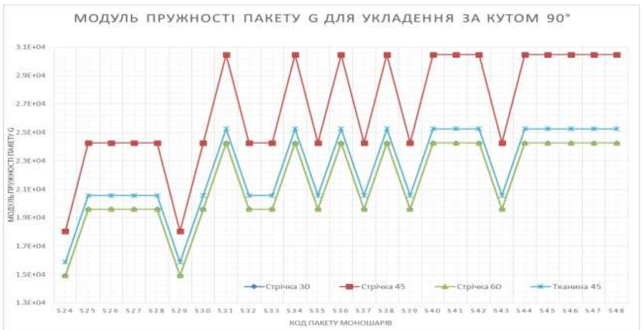
Рис. 3.10. Модулі зсуву для пакетів з кутами укладення 90° та 30°, 45°, 60°
