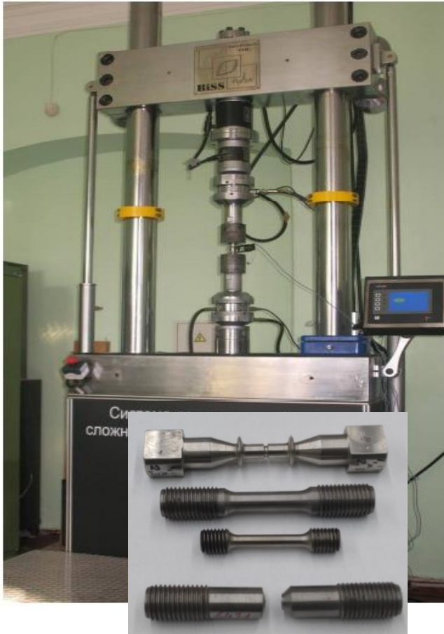
Установка для механічних випробувань та зразки матеріалу
